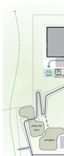
Tous les matériaux utilisés seront perméables. L'infiltration de l'eau dans le sol est donc favorisée. Pour la zone sur dalle de parking, l'eau est collectée sur la dalle et conduite vers un canal, elle est stockée dans un bassin périphérique et conduite dans une zone qui occultera l'eau afin de l'utiliser pour l'arrosage des parcs et du parc.
